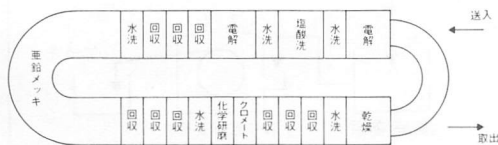
図1 自動亜鉛メッキ装置
