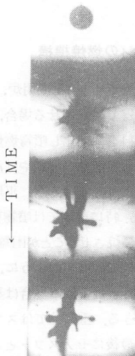
写-1 エマルジョン懸垂液滴の燃焼 12) (バンカーC)
