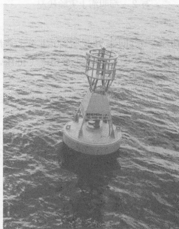
写-1 波力発電付, 航路標識ブイ
