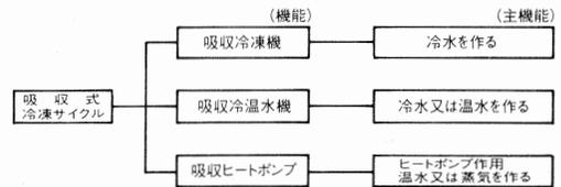
図-1 吸収式冷凍サイクルの応用
