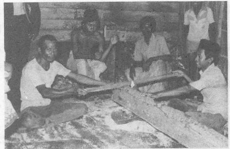
図-9 手動のラスパーを用いてサゴヤシの幹を粉末化する
