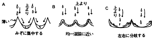
図-5 蒸発・吸収用ひれ付き伝熱面(水平管)の形状選択
