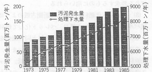
図-2 下水処理量と下水汚泥量の推移
