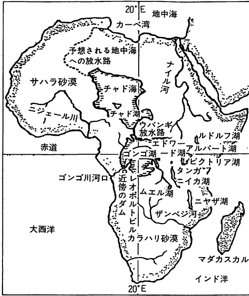
図-6 ゴンゴ湖およびチャド海が実現した場合のアフリカ予測図 2)
