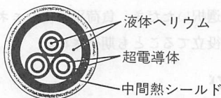
(b)超電導ケーブル (66KV, 1,000MW液体ヘリウム冷却)
