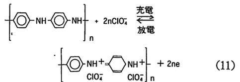
の反応が進み、電解質中の $\text{ClO}_4^-$ などのアニオンの挿入、脱離により充放電が進むため、負極にリチウムやリチウム合金を用いた場合、充電により電解質濃度が減少する。これは電解質も活物質として作用することを示し、電池容量が電解質の量によって制限され、大きいエネルギー密度は期待できない。リチウムイオンの挿入、脱離を行なわせると、黒鉛に代わる負極活物質としての応用も考えることができる。2,5-ジメルカプト-1,3,4-チアジアゾールなどの有機ジスルフィド化合物は重合、解重合により充放電が進む。これに電子導電性のポリアニリンを触媒として複合させた活物質も、高エネルギー密度を示す活物質として注目されている。
