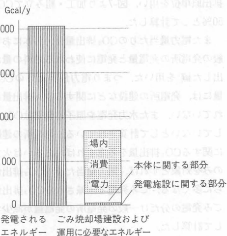
図-6 ごみ発電のエネルギー収支
