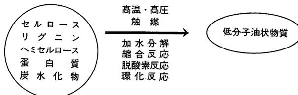
図-1 油化反応の模式図
