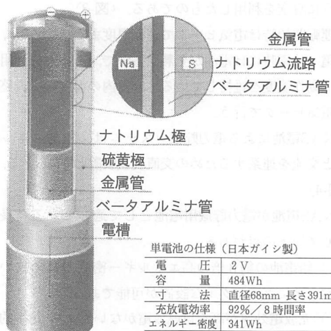
図-2 単電池構造
