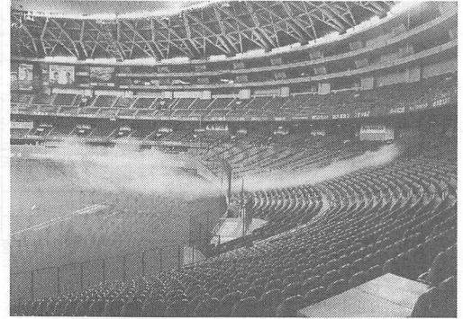
図-15 アリーナ空調気流の可視化
