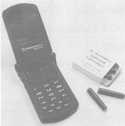
図8 Motorola社が試作したDMFC搭載携帯電話 右はメタノールカートリッジ
